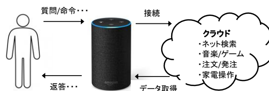
(図表2) スマートスピーカーの仕組み
